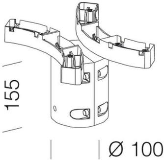
365 Fixação poste de duas lâmpadas
