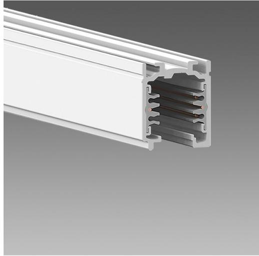
Omnitrack PLUS 6 conduttori: Il sistema binario Omnitrack PLUS è un sistema misto trifase con due conduttori aggiuntivi per la gestione di un qualsiasi segnale (per esempio DALI, DMX, ecc)
