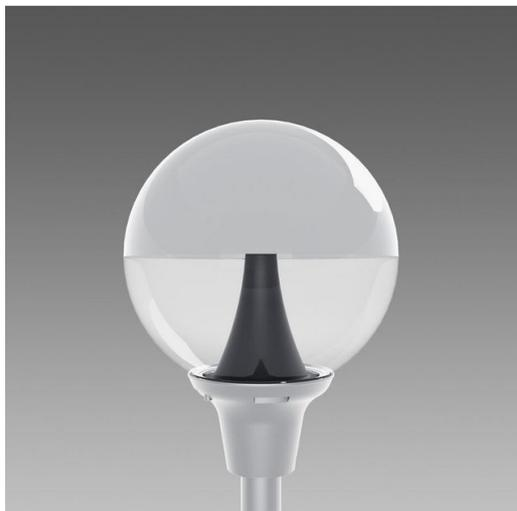
Globo: In policarbonato infrangibile ed autoestinguente V2, stabilizzato ai raggi UV, antiingiallimento. Ottima trasparenza ideale per la trasmissione del flusso luminoso. Parte superiore verniciata per rientrare nelle limitazioni delle norme contro l'inquinamento luminoso.
