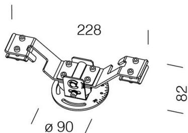
in acciaio inox AISI 304. Per l'applicazione su funi e cavi in acciaio.
