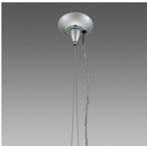
equipada con cable de acero L=1.75 con dispositivo para ajuste milimétrico y cable de alimentación. Carga máx.: 20 Kg.
