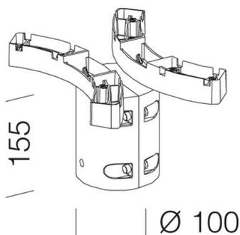
de aluminio fundido a presión. Para la instalación en columna diámetro 60 en versión de doble lámpara.
